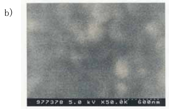
図10 試料回転法で得られたデプスプロファイルa)と分析後の表面SEM像b) 試料：Ni/Cr多層膜, イオン加速電圧：3kV
